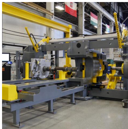
Figura 3-1 Prensa de rodas de 300 toneladas com registro gráfico
