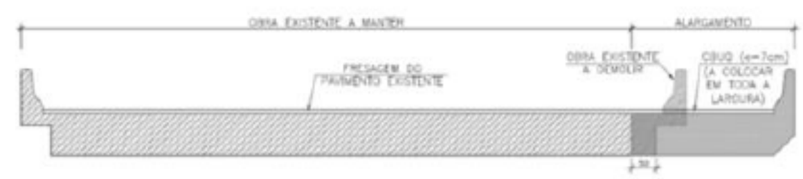
Figura 5 - Seção Transversal Típica em Obras de Alargamento – Tipo B
