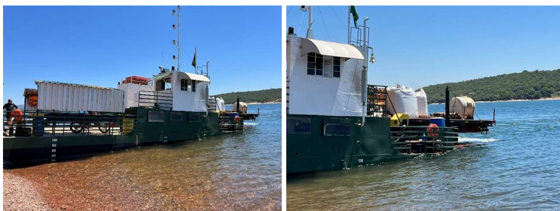
Figura 71 - Balsa Guapé - Vista Lateral - Balsa Sobrecarregada
